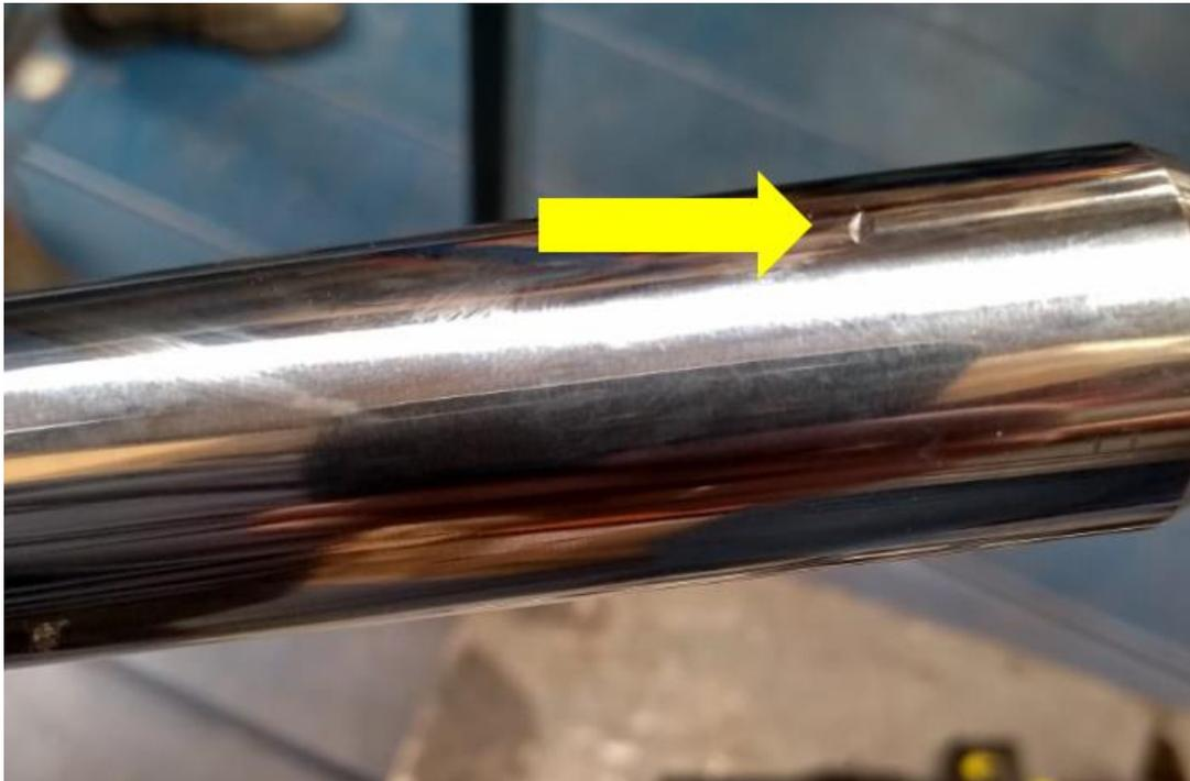
2.2 **Excesso de sujeira:** verificar se a haste não apresenta nenhuma sujeira, pois esta pode entrar no amortecedor e danificar o seu funcionamento. Esse problema pode ocorrer devido a utilização de uma coifa inadequada (danificada) ou até mesmo pela falta dela.
