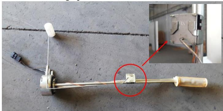
**1.5 – Boia Tubular quebrada (instalação, aplicação e/ou uso incorretos):**
